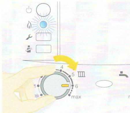
Den Temperaturregler nach rechts drehen um die maximale Vorlauf-temperatur an die Heizungsanlage anzupassen.
